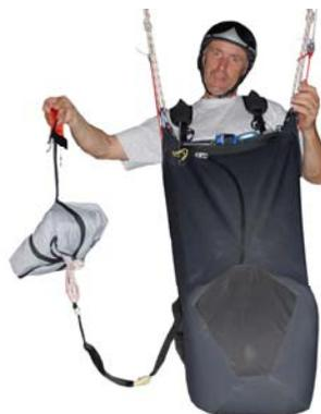
**ATTENZIONE:** per evitare anomali caricamenti laterali, la fune va agganciata a tutte due le asole poste sulle rispettive spalline. Non solo ad una delle due.
