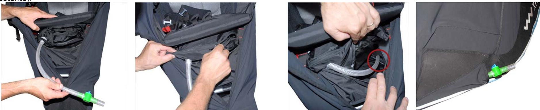
Il porta zavorra posto sotto il porta strumenti funziona più o meno con lo stesso principio. Aprire la cerniera del lembo di tessuto che ha funzione contenitiva, posizionare la sacca della zavorra in modo che il tubo di scarico e il foro presente siano allineati. Far scorrere il tubo di scarico tra la cinghia di regolazione dell'inclinazione della seduta e la cinghia portante principale e poi verso l'esterno dell'imbragatura.
